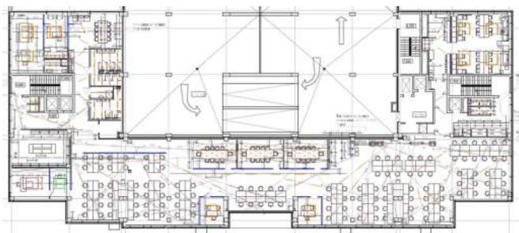
Но высота подвеса была всего 2,8 метра, что сильно осложняло задачу. Благодаря хаотической раскладке и небольшой высоте равномерность явно страдала. Выше размещаться не позволяли инженерные коммуникации (вентиляция и др.).
